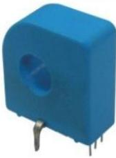
基于闭环磁平衡原理的一款霍尔电流传感器，能够测量直流，交流，脉冲以及 各种不规则电流等。传感器的输出能真实反映通电导体的真实波形。
